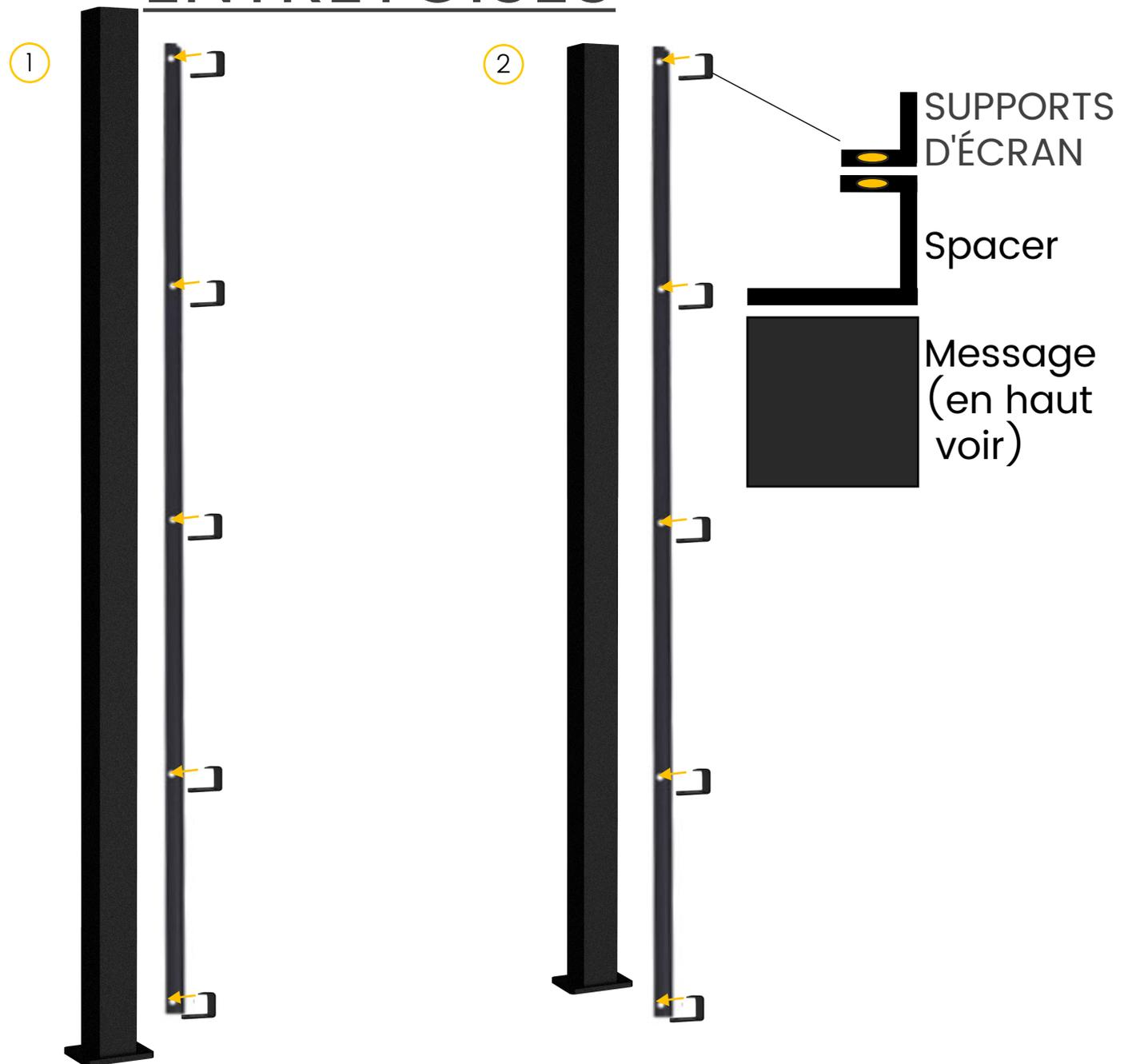
Fixez le côté des entretoises avec un seul trou horizontalement aux supports en L à l'aide de (5) écrous et boulons par support.
