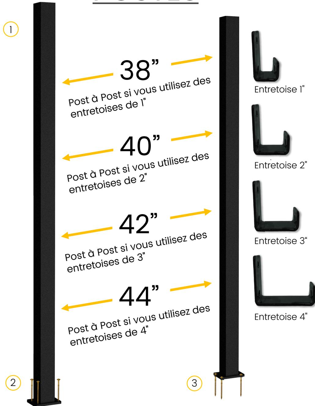
Montez les poteaux d'écran à 36 pouces l'un de l'autre. Mesurez poste à poste, pas de base à base. Fixez à la sous-structure du pont à l'aide de (4) vis structurelles pour pont / poteau d'écran.
